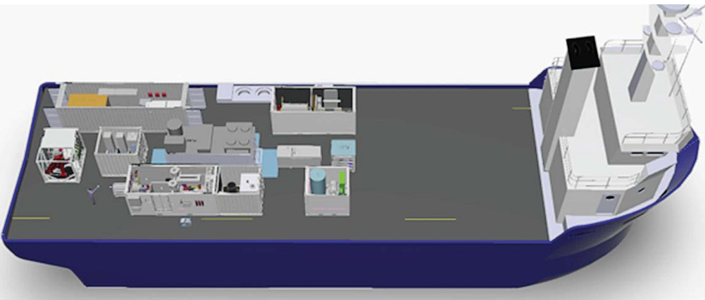
System do utylizacji broni chemicznej ma być posadowiony w kontenerach na statku.
